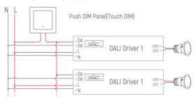
备注: 只能使用开路的按压式开关[不带指示灯]. 采用同步连线时每个设备和设备之间的线长不超过20米.
